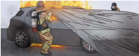
4. 펼쳐진 KEV-cover 양쪽에서 진입대원이 KEV-cover를 잡고 세로방향(9m)으로 전개하여 사고 차량을 덮는다.
